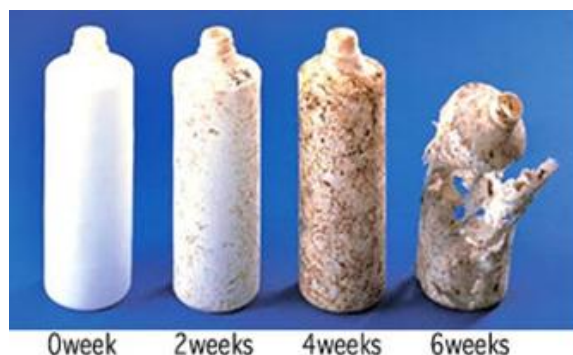
Figur 2. Nedbryting av flaske laget av Bionolle
